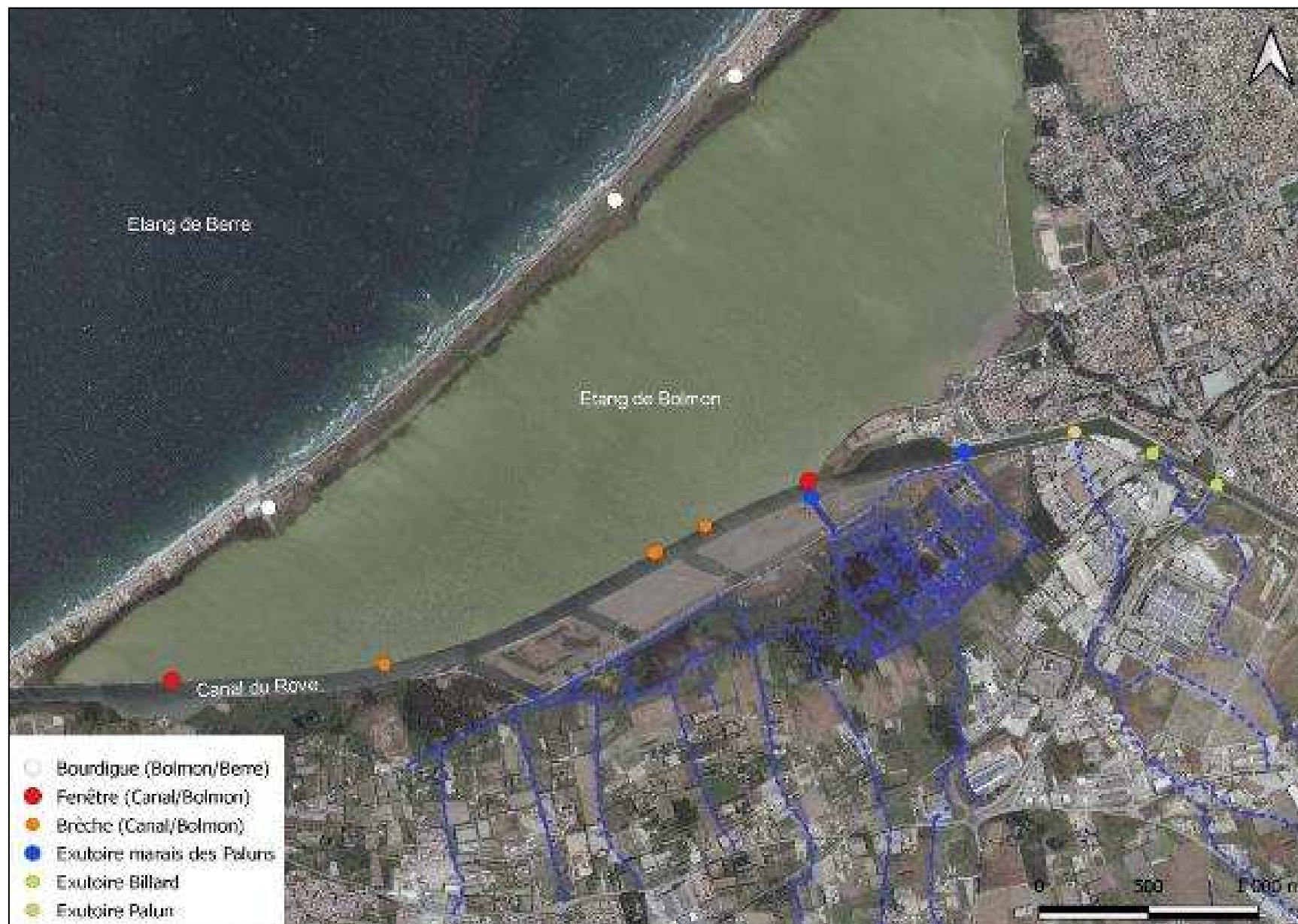
Figure 7 : Cartographie des exutoires et des ouvertures entre canal du Rove, Bolmon et Berre
